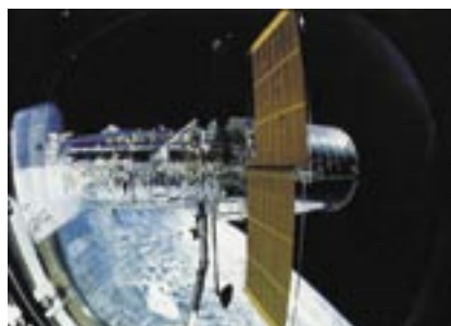
Abb. 08: Das Hubble-Weltraumteleskop (HST) saust in 600 km Höhe in 100 Minuten einmal um die Erde. Sein Hauptspiegel hat einen Durchmesser von 2,4 m und ermöglicht einen tiefen Blick in den Welt- raum. Im Gegensatz zu Teles- kopen auf der Erde behindert keine störende Atmosphäre die Sicht.
